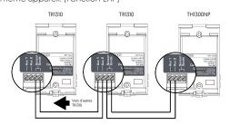
Deuxième étage de chauffage (Fonctions 15 sec / 15 min)
