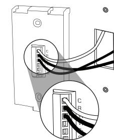
4 Utilisez les vis fournies pour fixer la base du thermostat au mur.
