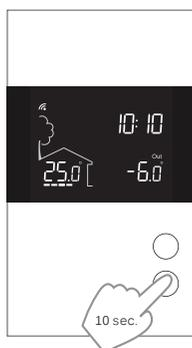
Appuyer sur les boutons ↓ et ↑ simultanément pour sélectionner le prochain paramètre. Continuer à appuyer jusqu'à la fin de la liste pour sortir du menu.
