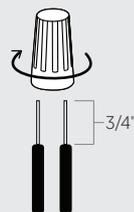
\* Des fils électriques mal installés pourraient brûler les capuchons de connexion.
