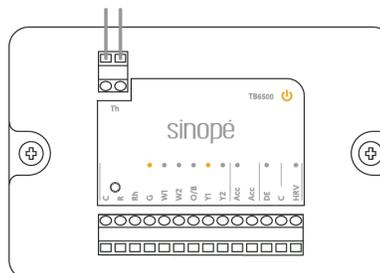
**Note :** Pour garantir une communication optimale entre le TH6500WF et le TB6500, il est fortement recommandé que la longueur des câbles ne dépasse pas 30 mètres (100 pieds).
